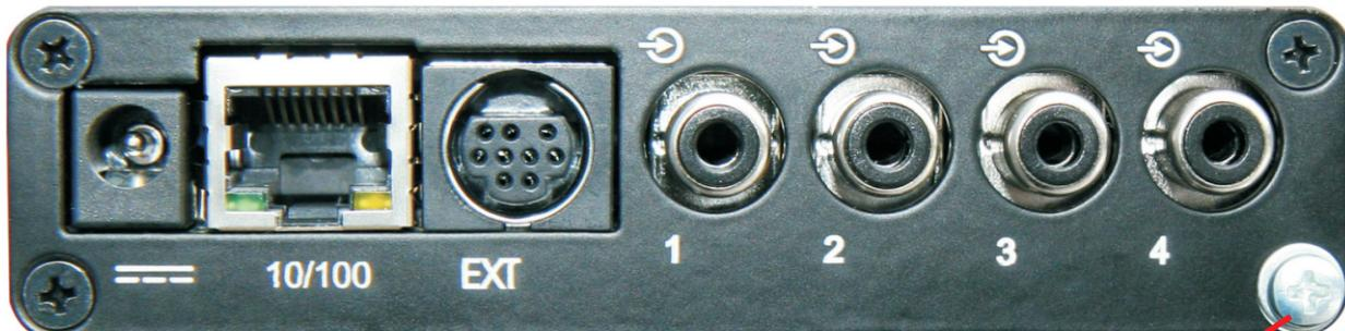
Винт (клемма) для заземления
