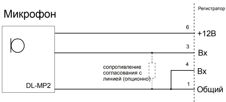
Рисунок 11. Схема подключения микрофона с питанием от регистратора.
