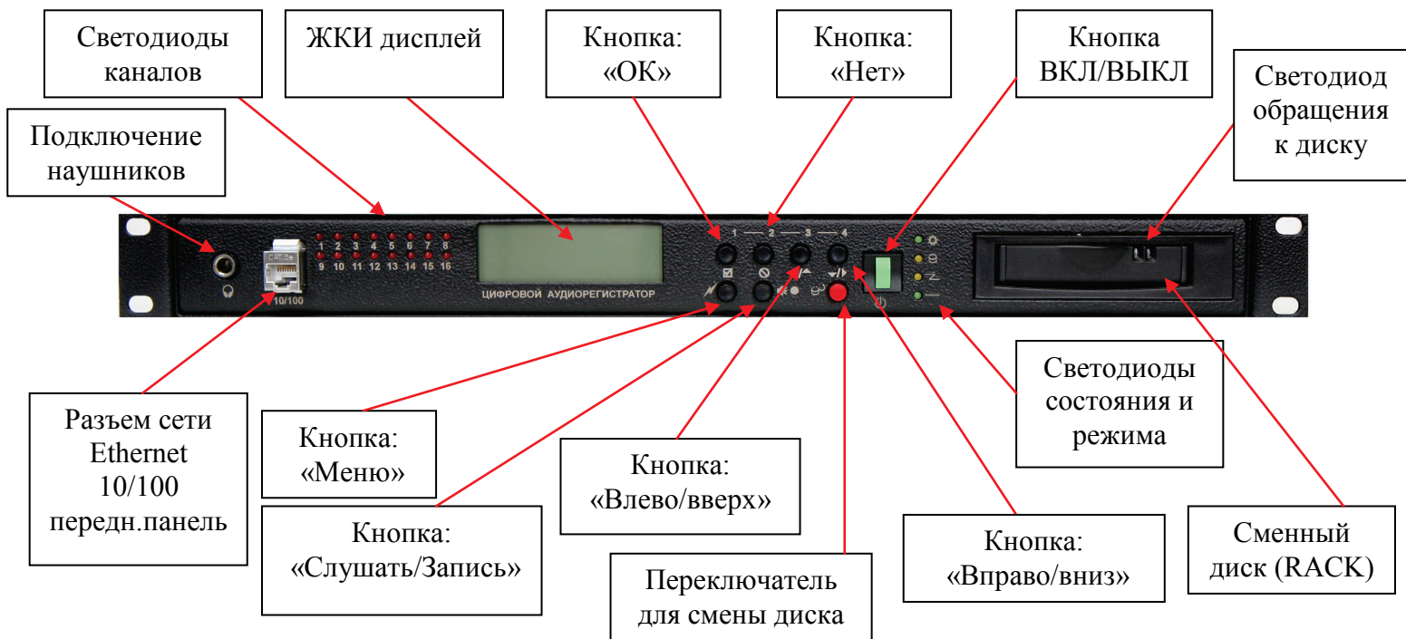
Рисунок 3. Передняя панель устройства (на примере MDL2-16-19" 1U-RACK).
