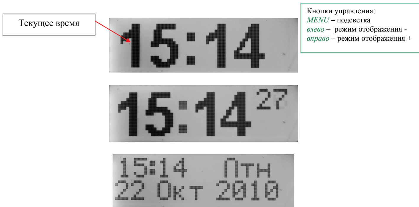
Рисунок 15. ЖКИ экран в режиме «выключено» с индикации текущего времени в различных режимах.
