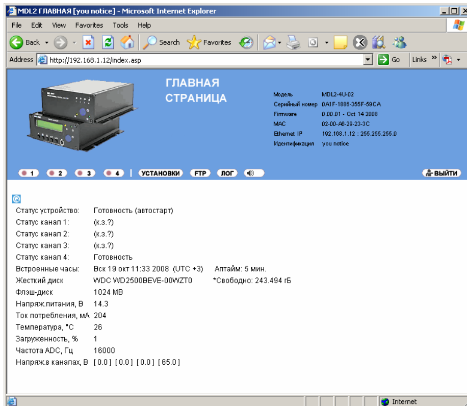
Рисунок 13. Встроенный HTTP сервер. Главная страница.
