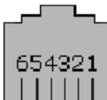
Рисунок 4. Гнездо RJ-12.
