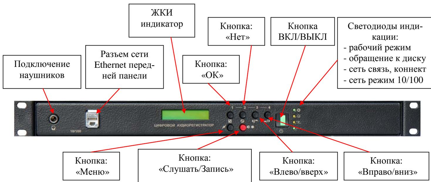
Рисунок 7. Передняя панель устройства. Исп. -19" 1U.
