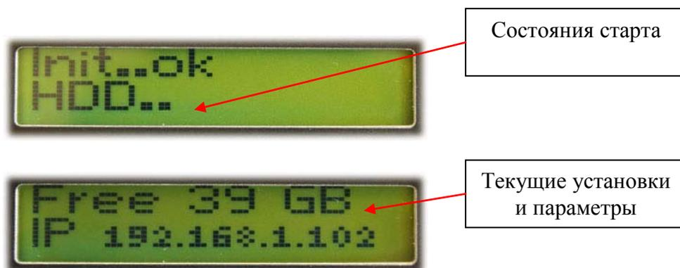
Рисунок 5. Отображение на ЖКИ старта устройства.
