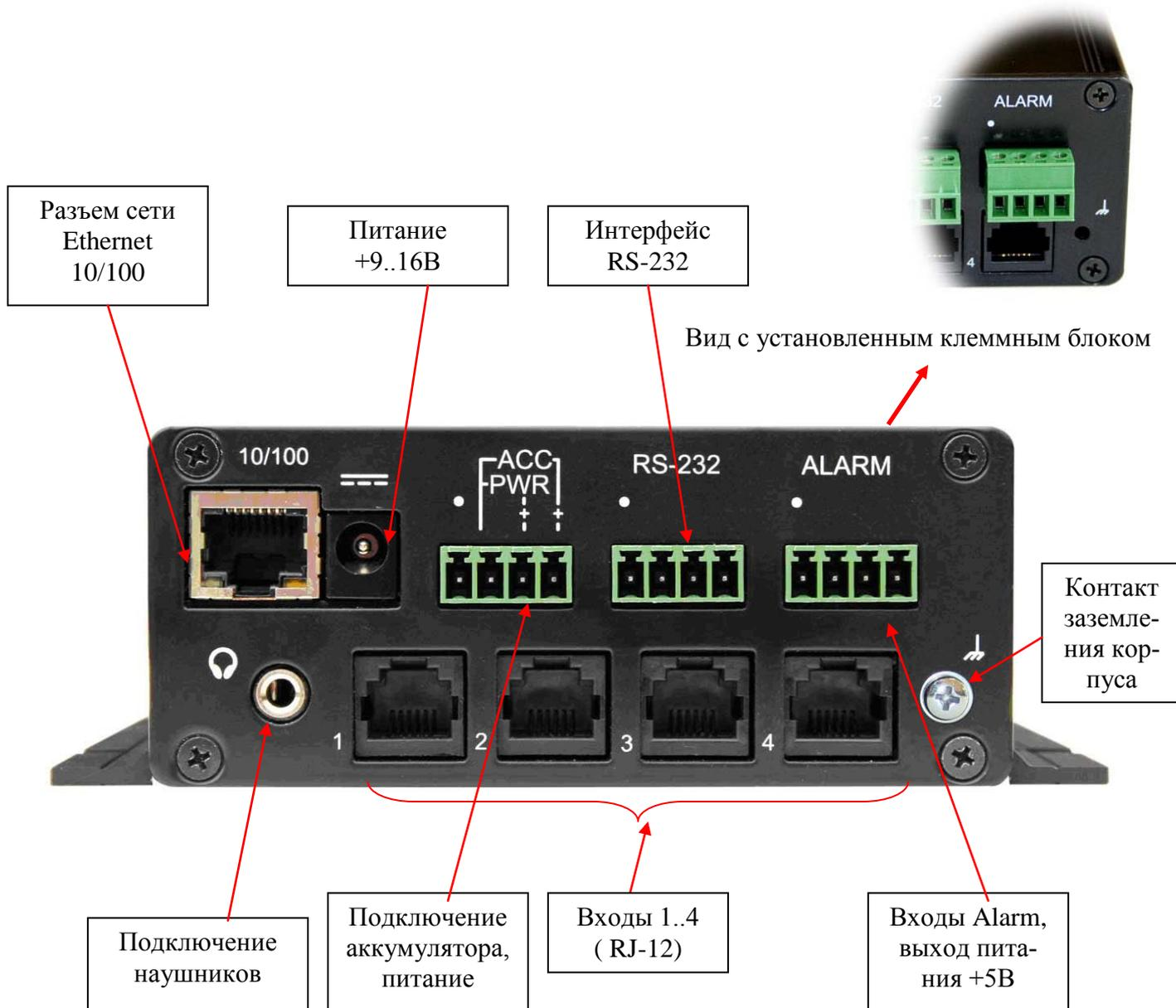
Рисунок 3. Задняя панель устройства. Исп. -02.
