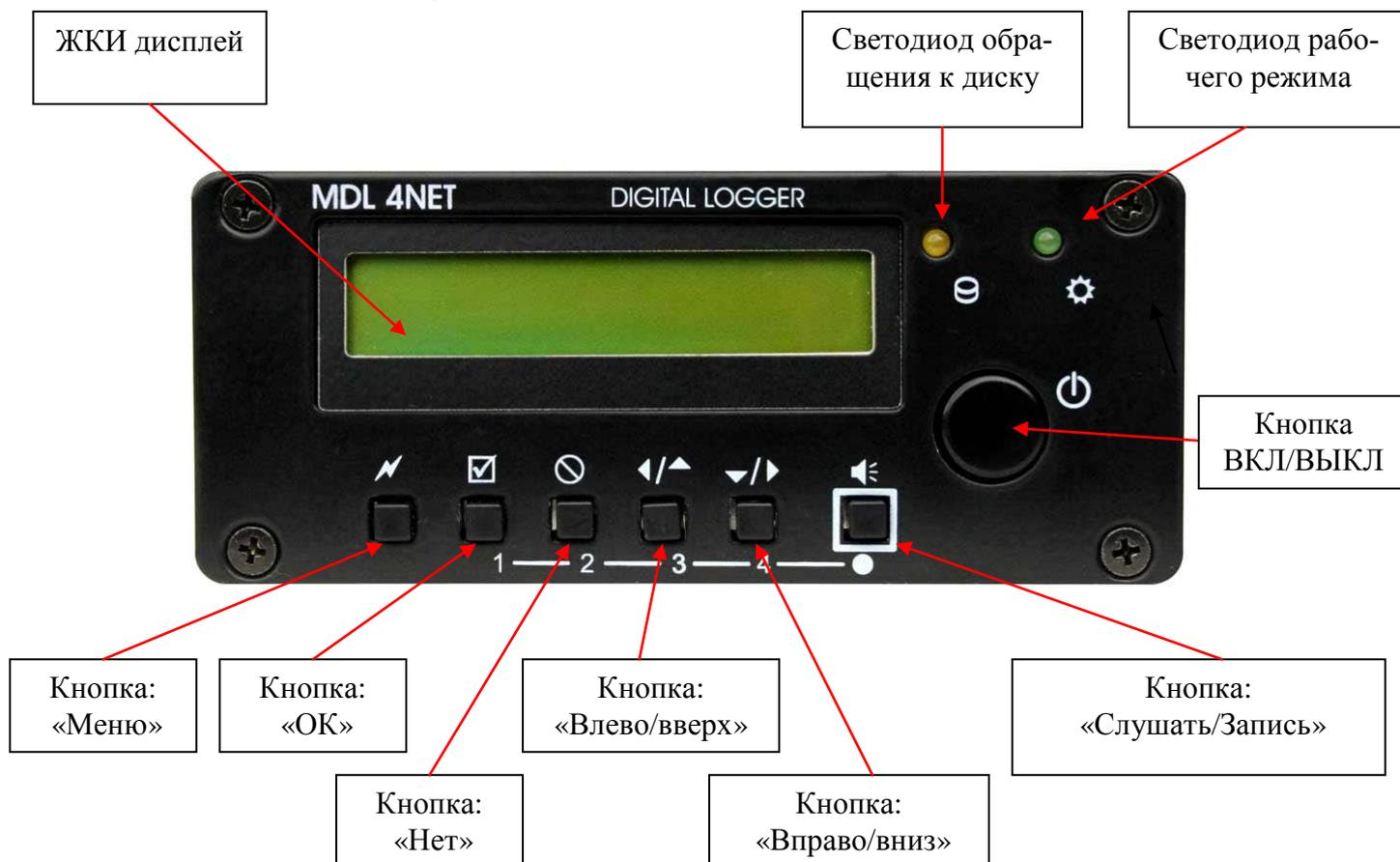
Рисунок 2. Передняя панель устройства. Исп. -02.
