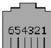
Рисунок 11. Гнездо RJ-12.
