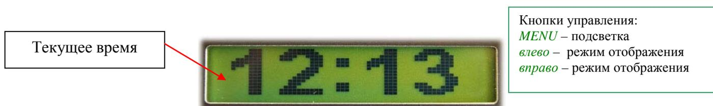
Рисунок 13. ЖКИ экран в режиме «выключено» с индикации текущего времени.
