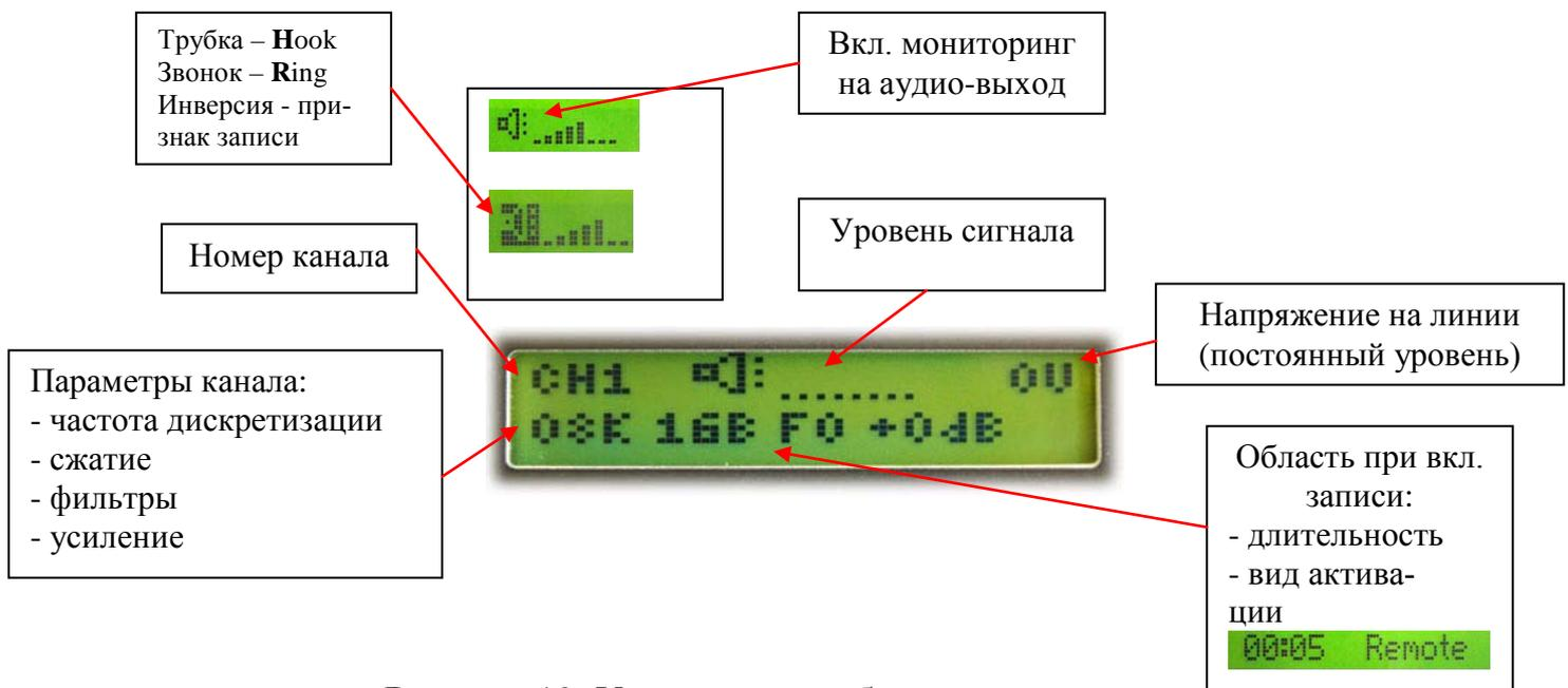
Рисунок 19. Управление выбранным каналом.
