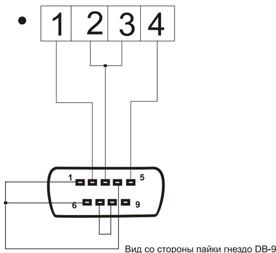
Рисунок 12. Вариант подключения к ПК по RS-232.
