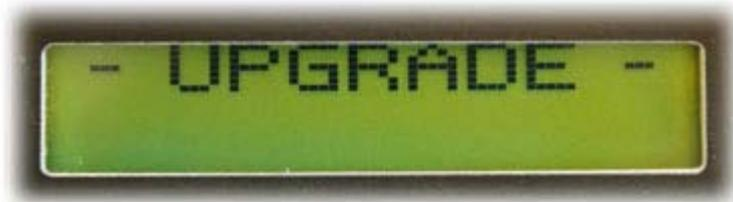
Рисунок 27. Индикация режима обновления на ЖКИ.
