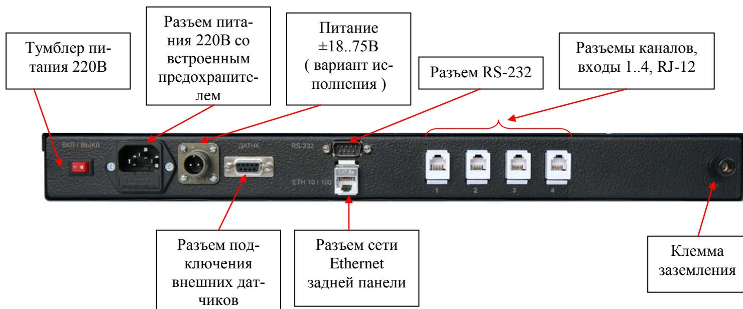
Рисунок 8. Задняя панель устройства. Исп. -19" 1U.
