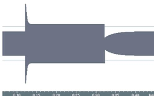
Рисунок 48. Пример. Звук до и после обработки компрессором.
