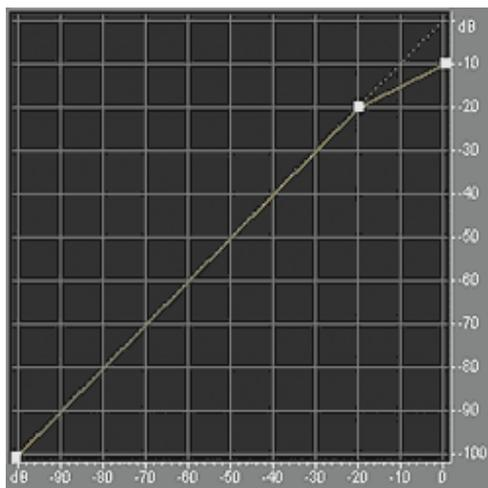
Рисунок 47. Пример. Передаточная характеристика компрессора.
