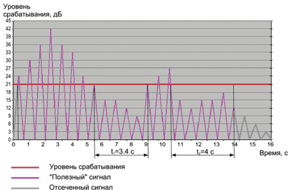
Рисунок 55. Принцип работы режима «Акустопуск».
